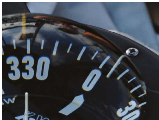
Als Steuerkompass geeigneter Magnetkompass
